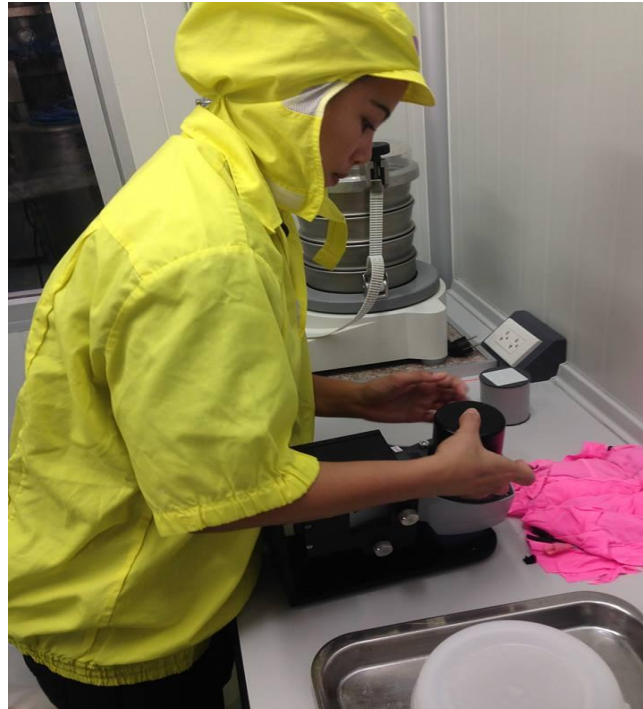
รูปที่ 9 พนักงาน QA นำกากมะพร้าวอบแห้งมาตรวจวัดความเหลือง
