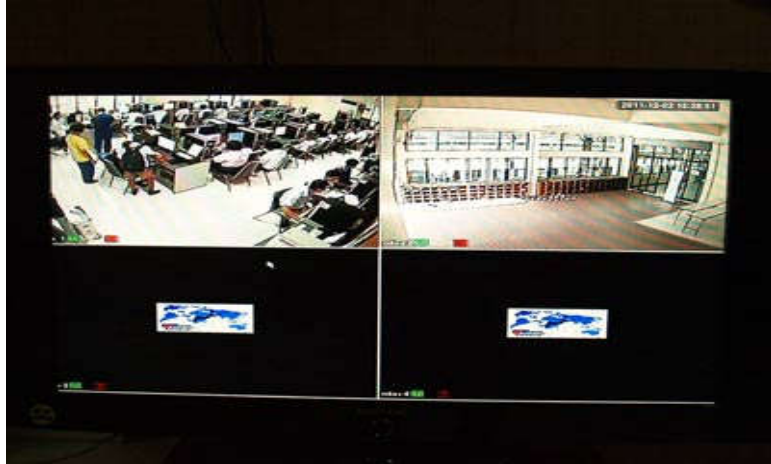
รูปที่ 4.5 ภาพดับหรือไม่มีภาพเลย เป็นบางกล้อง ทุกช่วงเวลา
