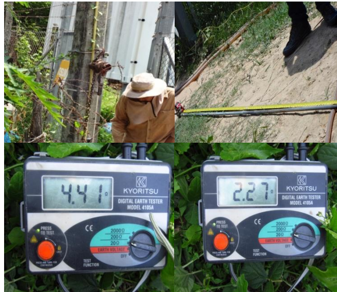
รูปที่ 4.3 แสดงการวัดความยาวของสายดินให้ถูกต้องตามมาตรฐาน
