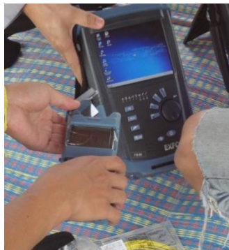
รูปที่ 4.4 แสดงการวัดความเข้มของแสงด้วยเครื่อง OPM
