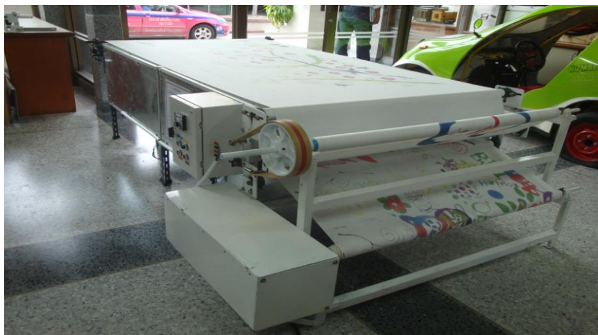
รูปที่ 3.5 โต๊ะเขียนผ้าบาติกที่สร้างจริง
