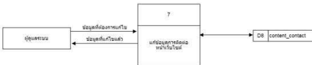
รูปที่ 3.10 Data Flow Diagram Level 1 ส่วนของแก้ไขข้อมูลการติดต่อหน้าเว็บไซต์
