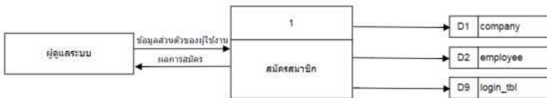
รูปที่ 3.4 Data Flow Diagram Level 1 ส่วนของสมัครสมาชิก
