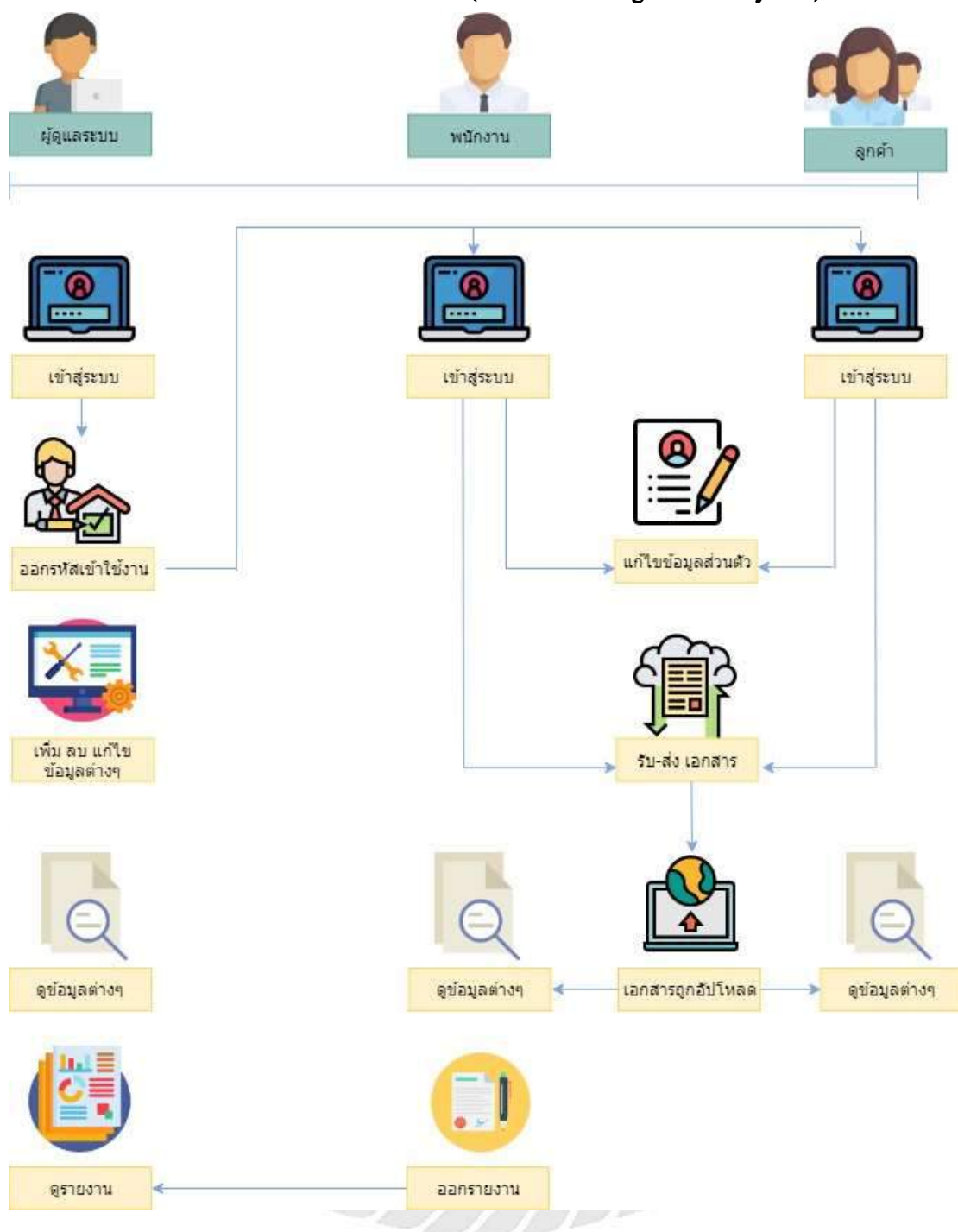
รูปที่ 3.2 Work Flow Diagram ของเว็บแอปพลิเคชันบริหารจัดการเอกสารฝ่ายการตลาด (กรณีศึกษา บริษัท แอนาไลติกอล ลาบอราทอรีส์ เซอร์วิส จำกัด)
