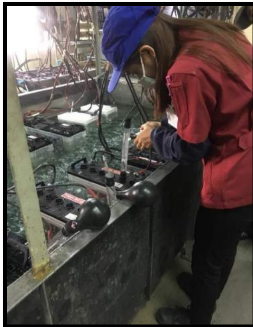
รูปที่ 10 เก็บค่าความถ่วงจำเพาะในขณะที่ชาร์จแบตเตอรี่
