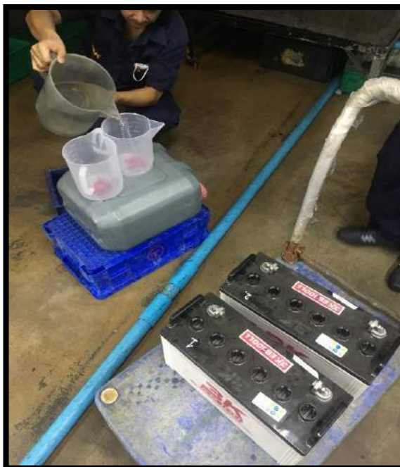
รูปที่ 3.3 ขั้นตอนการเตรียมน้ำกรดที่ใช้ในการเติมแบตเตอรี่ทดสอบ
