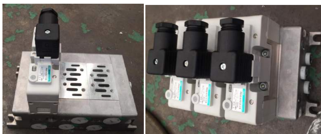
รูปที่ 4.2 การติดตั้งโซลินอยด์วาล์วเข้ากับฐาน
