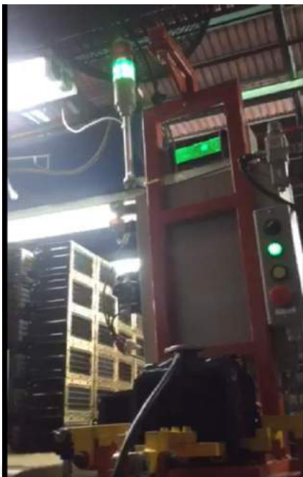
รูปที่ 4.25 การแสดงผลจากการตรวจสอบชิ้นงานที่ไม่รั่ว (OK) ด้วย LED สีเขียว
