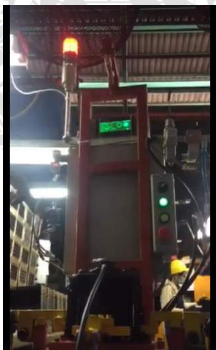
รูปที่ 4.26 แสดงผลจากการตรวจสอบชิ้นงานที่รั่ว (NG) ด้วย LED สีแดง
