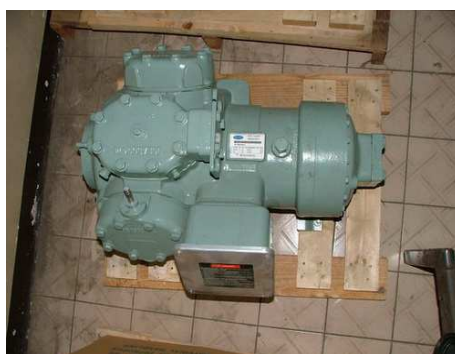
รูปที่ 2.2 คอมเพรสเซอร์แบบลูกสูบ(Reciprocating compressor)
