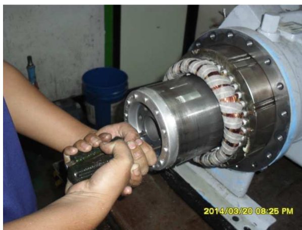
รูปที่ 3.7 การถอดโรเตอร์
