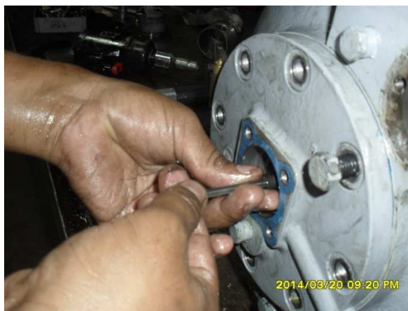
รูปที่ 3.15 การถอดน็อตล็อกเพลลา
