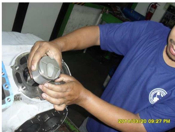
รูปที่ 3.13 การถอดลูกสูบและก้านสูบออกจากเสื้อสูบ
