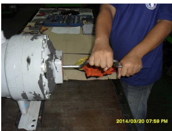
รูปที่ 3.2 การหมุนเช็คการทำงานของกลไกคอมเพรสเซอร์
