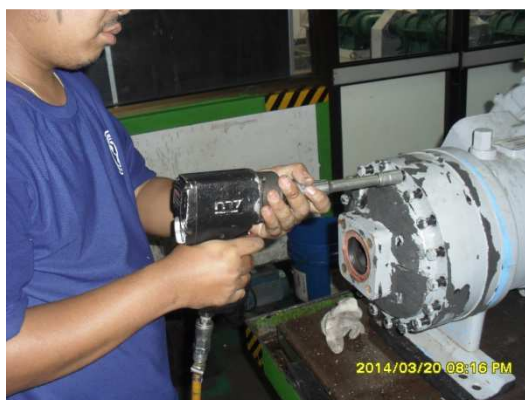
รูปที่ 3.5 การถอดฝาครอบมอเตอร์
