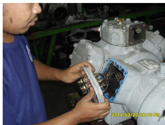
รูปที่ 3.4 การถอดชุดเทอร์มินอลเพจหรือขั้วต่อไฟฟ้า
