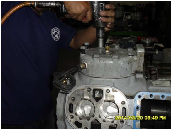
รูปที่ 3.9 การถอดฝาสูบ
