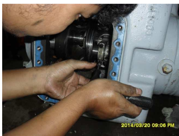
รูปที่ 3.12 การถอดน็อตยึดก้านสูบ
