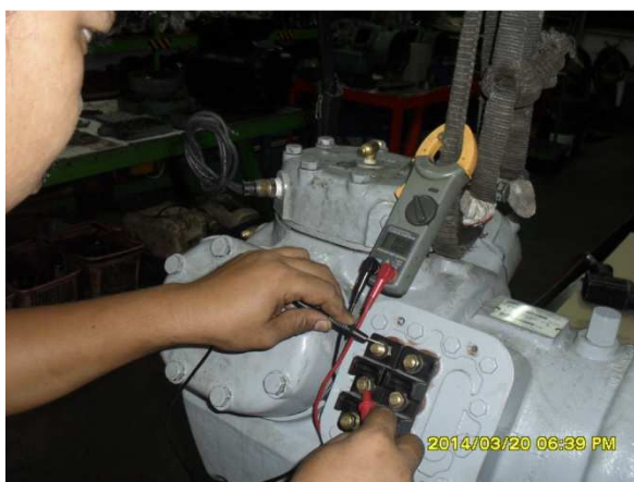
รูปที่ 3.1 การตรวจวัดค่าความต้านทานของขดลวด
