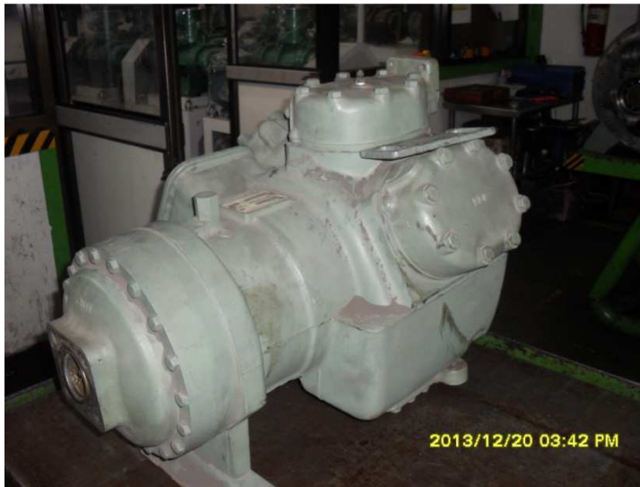
รูปที่ 4.1 คอมเพรสเซอร์แบบลูกสูบยี่ห้อ Carrier ขนาด 30 hp
