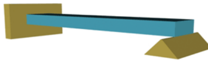
รูปที่ 3.4 คานปลายยื่นแต่มีจุดรับที่ปลายยื่น (Restrained Beam)
