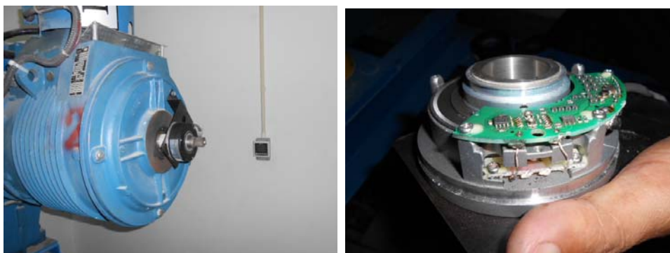
รูปที่ 4.2. อุปกรณ์วัดความเร็วรอบของมอเตอร์ลิฟท์ที่ชำรุด
