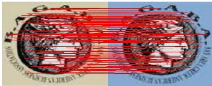
รูปที่ 3.13 ตัวอย่างการทำงานของอัลกอริทึม SIFT
