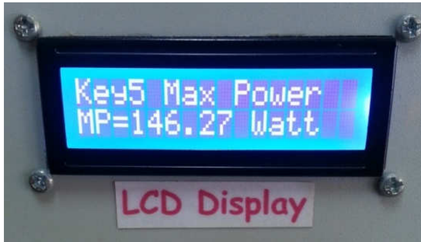
รูปที่ 4.9 หน้าจอจะแสดงค่ากำลังไฟฟ้าสิ้นเปลืองสูงสุดในช่วงเวลาทุก ๆ 15 นาที
