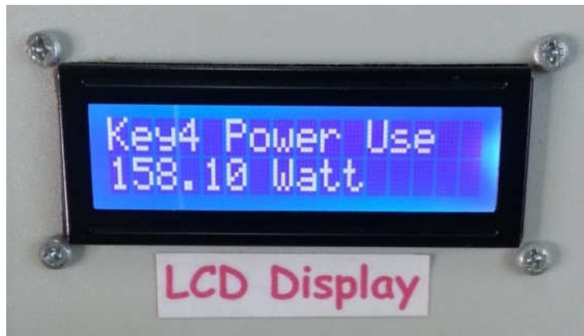
รูปที่ 4.8 หน้าจอจะแสดงค่ากำลังไฟฟ้าสิ้นเปลือง
