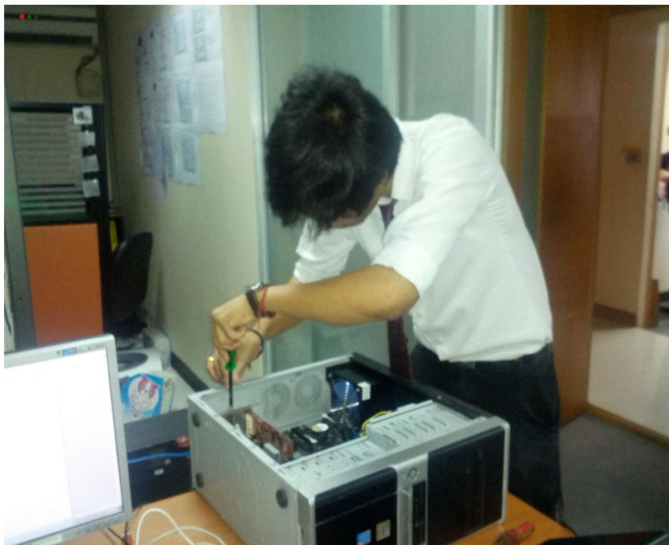
ภาพที่ ก.6 ใส่การ์ดแลน เตรียมคอมสำหรับทำเครื่องเซิร์ฟเวอร์
