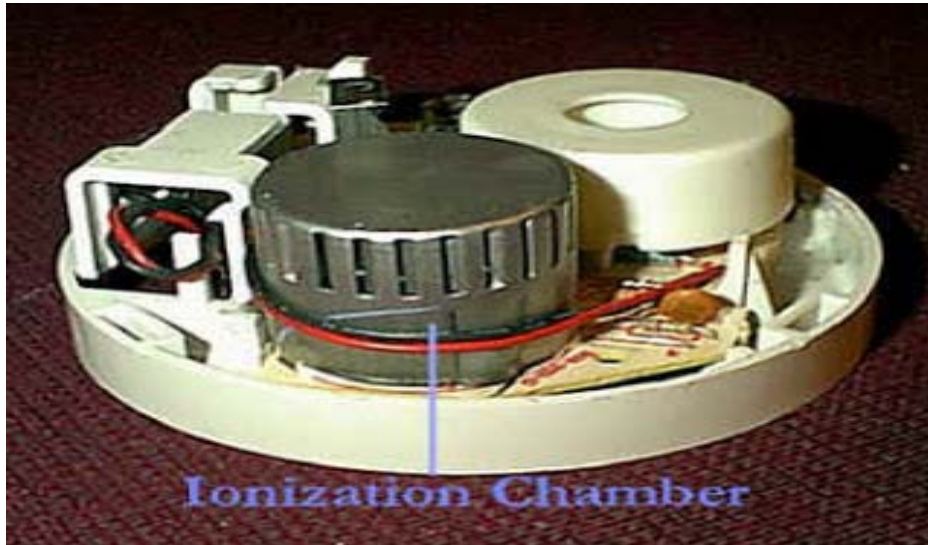
รูปที่ 2.1 ภายในอุปกรณ์ตรวจจับควันชนิด ไอโอไนเซชัน (Smoke Detector Ionization Type)
