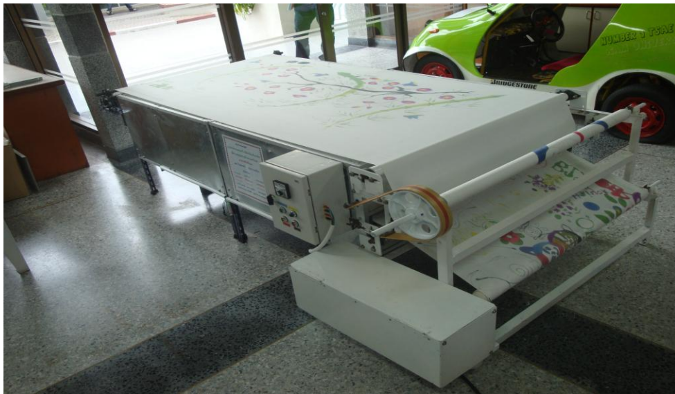
รูปที่ 4.1 โตะเขียนผ้าบาติกที่ควบคุมอุณหภูมิโดยวงจรรีเลย์
