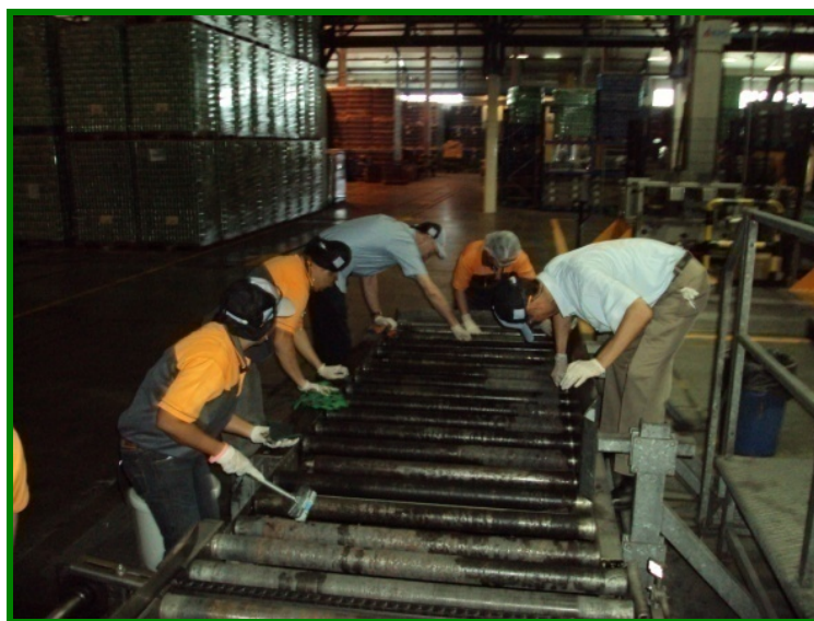
ภาพที่ 5.3 การทำ TCO เครื่องป้อนกระป๋องบริเวณลูกกลิ้งทางเข้าพาเลทของกระป๋อง
