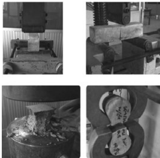
ภาพที่ 3 ทดสอบคุณสมบัติทางกลของวัสดุเคลือบผิวคลอง
