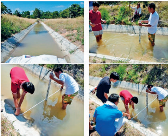
รูปที่ 16 วัดหน้าตัดและความลึกของน้ำในคลองสำหรับใช้คำนวณการรั่วซึม
