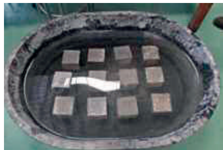
รูปที่ 5 ทดสอบการดูดซึมน้ำมอร์ตาร์ผสมน้ำยาง
