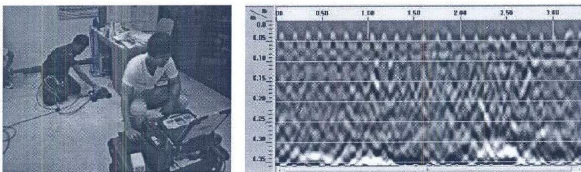
รูปที่ 8 แสดงผลการตรวจสอบตำแหน่งเหล็กเสริมโครงสร้างโดยเครื่อง GPR
