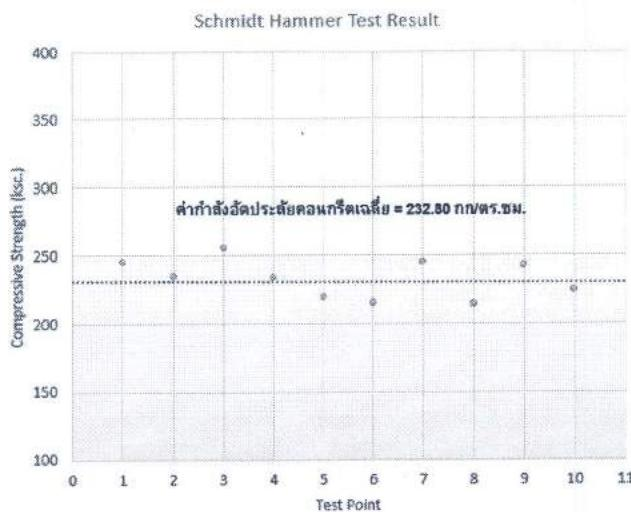
รูปที่ 5 ค่ากำลังอัดประดับของคอนกรีต ด้วยวิธี Rebound Hammer-Schmidt
