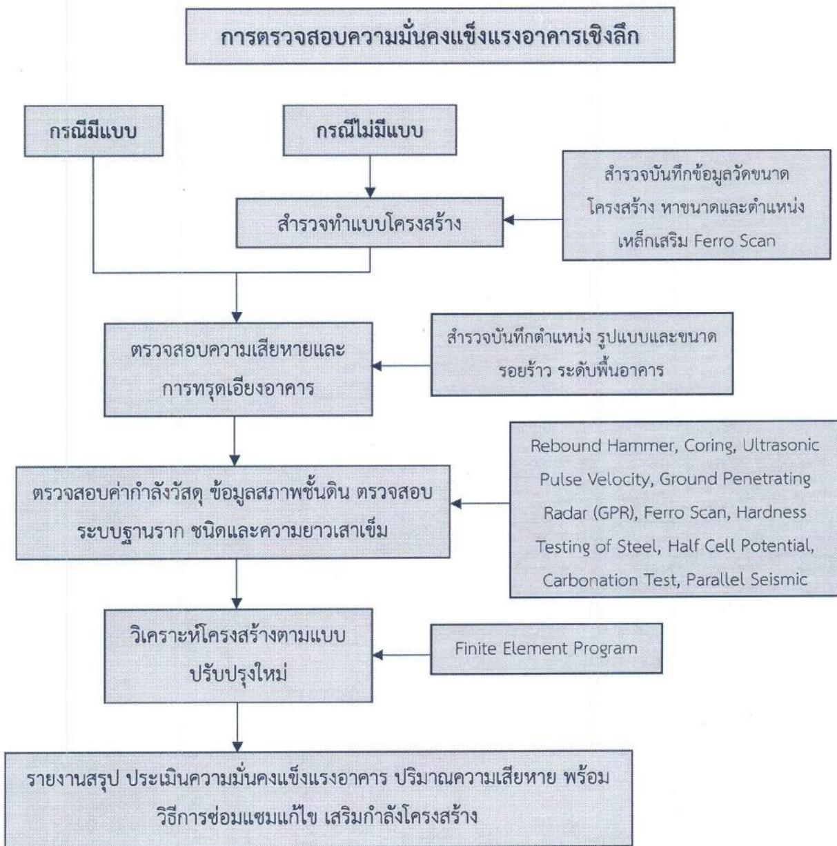
รูปที่ 2 แผนภาพแสดงขั้นตอนการตรวจสอบความมั่นคงแข็งแรงอาคาร [1]
