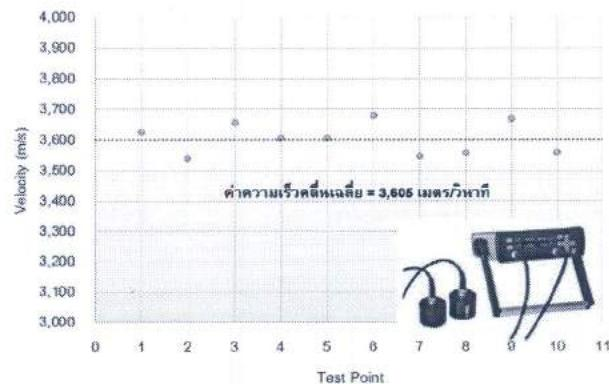
รูปที่ 7 เกณฑ์การทดสอบและผลค่าความเร็วคลื่นจากการทดสอบเครื่องอัลตราโซนิก
