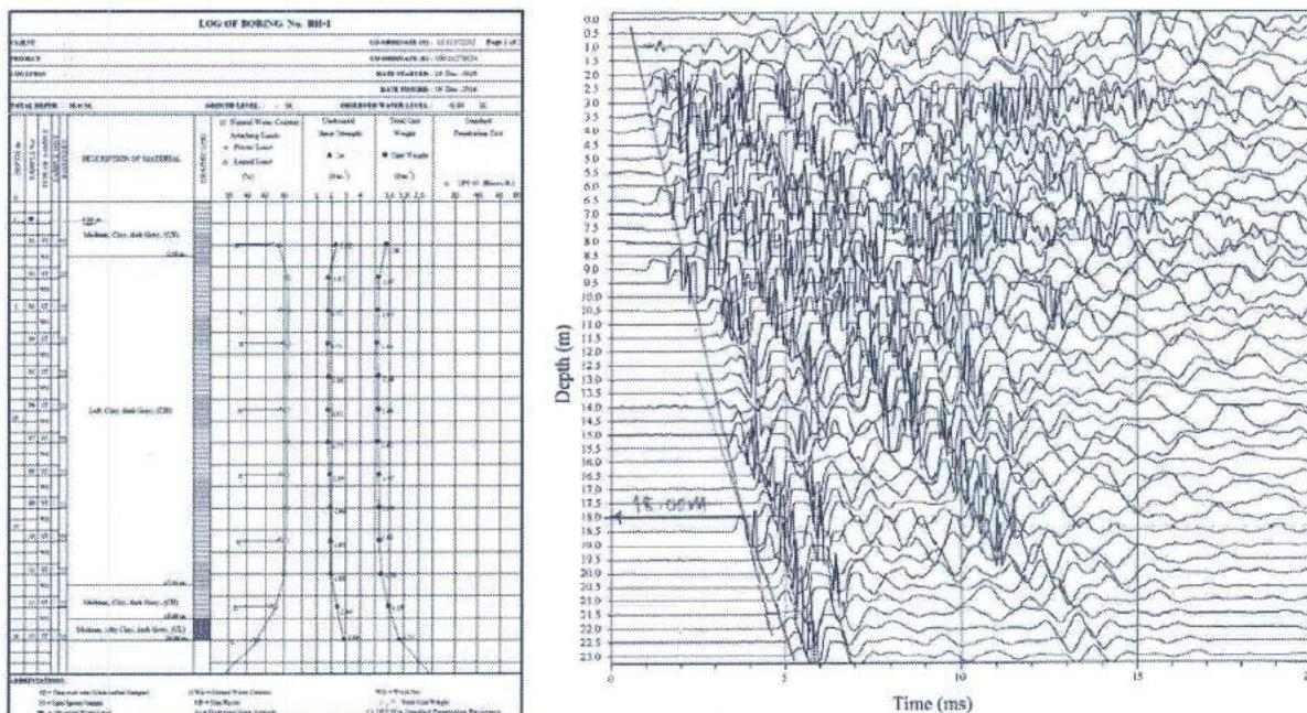
รูปที่ 10 ข้อมูลงานเจาะสำรวจสภาพขั้นดิน และผลการทดสอบหาความเยาเข้มโดยวิธี Parallel Seismic
