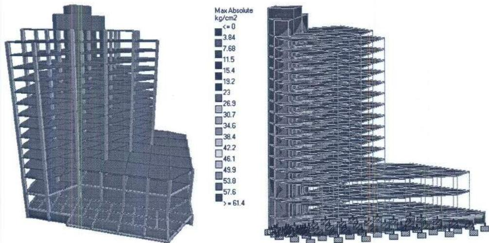
รูปที่ 12 แบบจำลองสามมิติโครงสร้างอาคารและผลการวิเคราะห์หน่วยแรงต่างๆ
