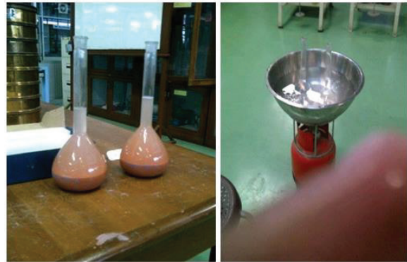
รูปที่ 1 ภาพขณะทดลองหาค่าความถ่วงจำเพาะของดิน
