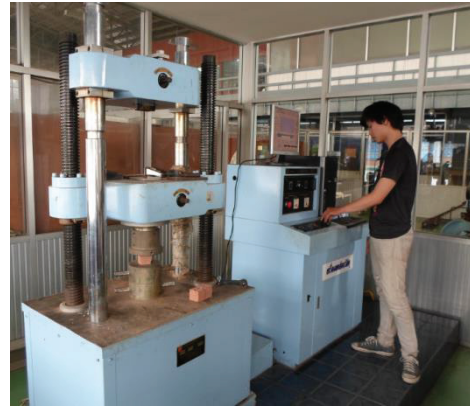
รูปที่ 3 ทดสอบกำลังรับแรงอัดดินซีเมนต์ผสมน้ำยางพารา
