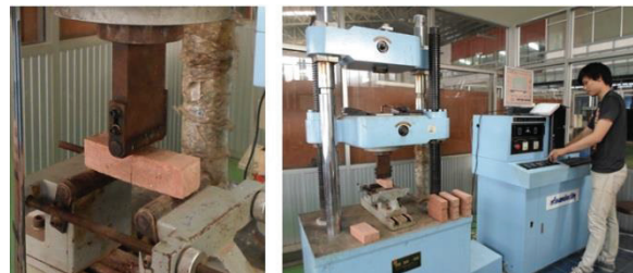
รูปที่ 3 ทดสอบกำลังรับแรงดัดดินซีเมนต์ผสมน้ำยางพารา
