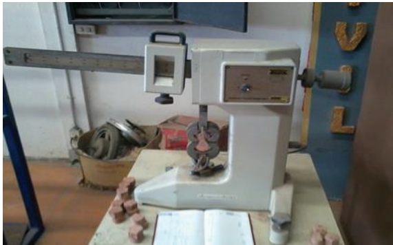
รูปที่ 4 การทดสอบกำลังรับแรงดึงดินซีเมนต์ ผสมน้ำยางพารา
