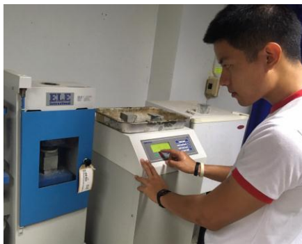
รูปที่ 3 การทดสอบกำลังรับแรงอัดของมอร์ตาร์
