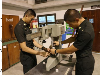
รูปที่ 4 การทดสอบสอปกำลังรับแรงดึงของมอร์ตาร์
