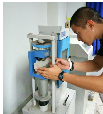
รูปที่ 5 การทดสอบกำลังรับแรงดัดของมอร์ตาร์
