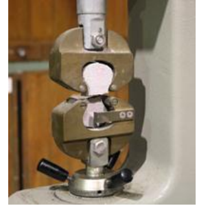
รูปที่ 4 การทดสอบสอปกำลังรับแรงดึงของมอร์ตาร์
