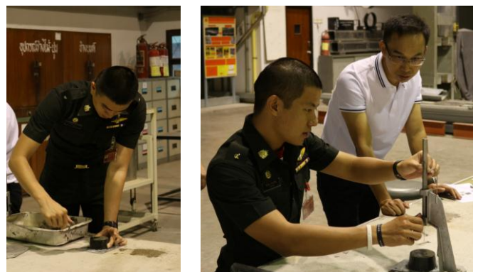
รูปที่ 2 การทดสอบระยะเวลาการก่อตัวเริ่มต้นของปูนซีเมนต์ผสมน้ำยางพารา
