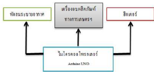
รูปที่ 2 ไคอะแกรมการทำงาน เครื่องอบผลิตภัณฑ์ทางการเกษตร
