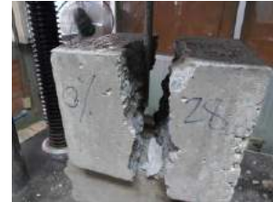
รูปที่ 6 การทดสอบแรงยึดเหนี่ยวของคอนกรีตผสมน้ำยางพารากับเหล็กเสริม
