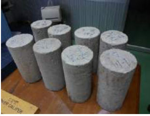
รูปที่ 4 ตัวอย่างทดสอบและการทดสอบกำลังรับแรงดึงของคอนกรีต
