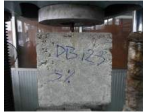
รูปที่ 6 การทดสอบแรงยึดเหนี่ยวของคอนกรีตผสมน้ำยางพารากับเหล็กเสริม
