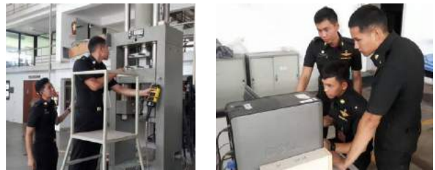
รูปที่ 3 การทดสอบกำลังรับแรงอัดของคอนกรีต
