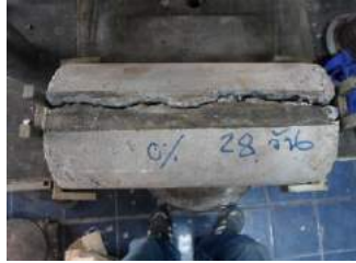
รูปที่ 4 ตัวอย่างทดสอบและการทดสอบกำลังรับแรงดึงของคอนกรีต
