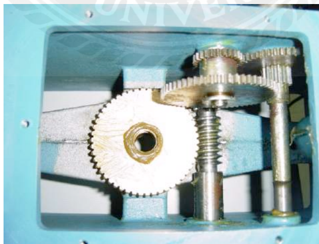
รูป 2.1.5 ระบบส่งกำลังขับเคลื่อนเพลาทดตัวอย่างอยู่ใต้เฟลม
