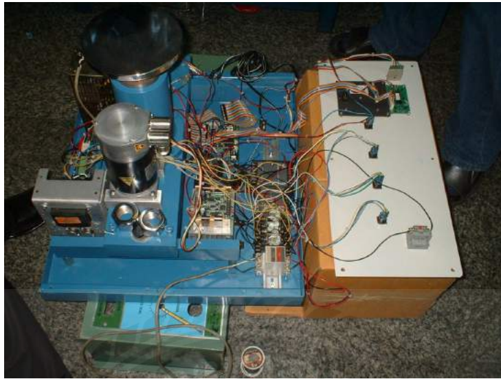
รูป 3.8 7 ส่วนประกอบภายใน โดยเอาแต่ละส่วนที่ออกแบบมารวมกันเป็นเครื่องทดสอบกำลังอัดคิน
