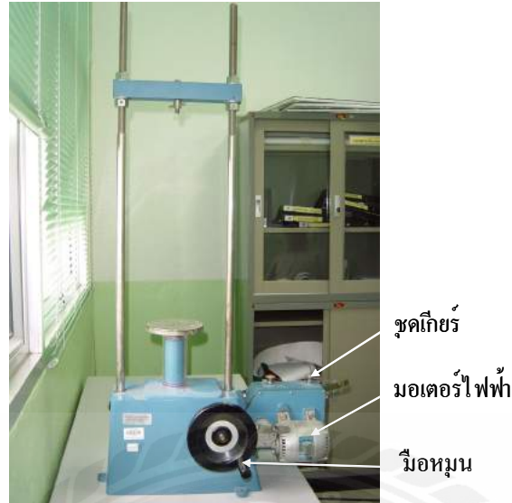
รูป 2.1.3 แสดงโหลดเพลมแบบสองเสาใช้มอเตอร์ไฟฟ้าหรือใช้มือหมุนก็ได้รุ่น Tritest 10 kN
