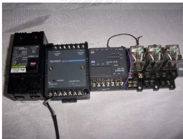
รูป 3.8.6 ส่วนวงจรควบคุมการทำงานเคลื่อนที่ขึ้น - ลง - หยุด ของเครื่องทดสอบโดยใช้ PLC
