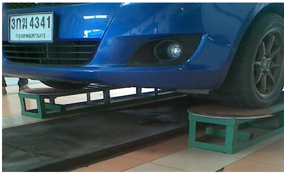
รูปที่ 8 รถทดสอบขณะทำการวัดมุมเลี้ยว
