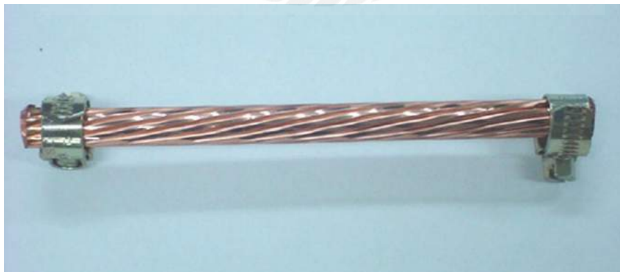
รูปที่ 2.5 ตัวนำแบบ Concentric แบบกึ่งอัดแน่น(Compressed)
