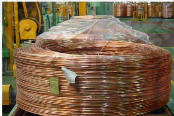
รูปที่ 2.2 ตัวนำ Copper wire rod 8.0 มม.
