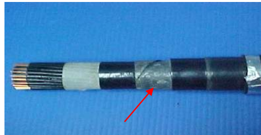
รูปที่ 2.23 สายไฟที่มี Steel tape armour
