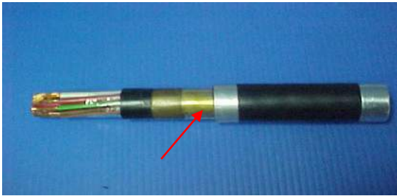
รูปที่ 2.22 สายไฟที่มี Brass tape armour
