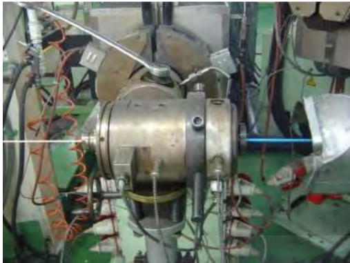
รูปที่ 2.10 การหุ้มฉนวนสายไฟฟ้า แรงดันไม่เกิน 1 kV รูปที่ 2.11 การหุ้มเปลือกสายไฟฟ้า
