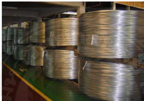
รูปที่ 2.1 ตัวนำ Aluminium wire rod 9.53 มม.
