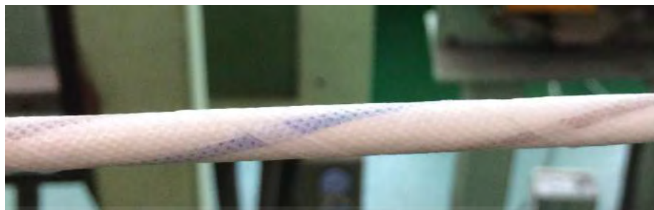
รูปที่ 4.25 ตัวอย่างการพันเทปแบบ 1/5 Lap (Spun bond tape)
