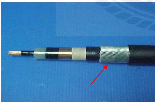
รูปที่ 2.20 สายไฟที่มี Aluminium wire Armour
