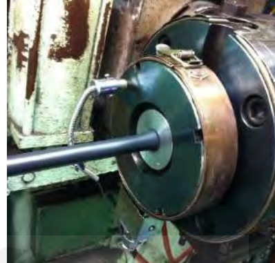
รูปที่ 2.10 การหุ้มฉนวนสายไฟฟ้า แรงดันไม่เกิน 1 kV รูปที่ 2.11 การหุ้มเปลือกสายไฟฟ้า
