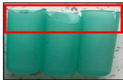
รูปที่ 7 ลักษณะการฉีดไม่เต็มบนชิ้นงาน
