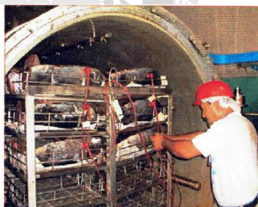
รูปที่ 2.38 นำรตะกร้าปลาเข้าหม้อนึ่ง เสียบหัววัดอุณหภูมิ
