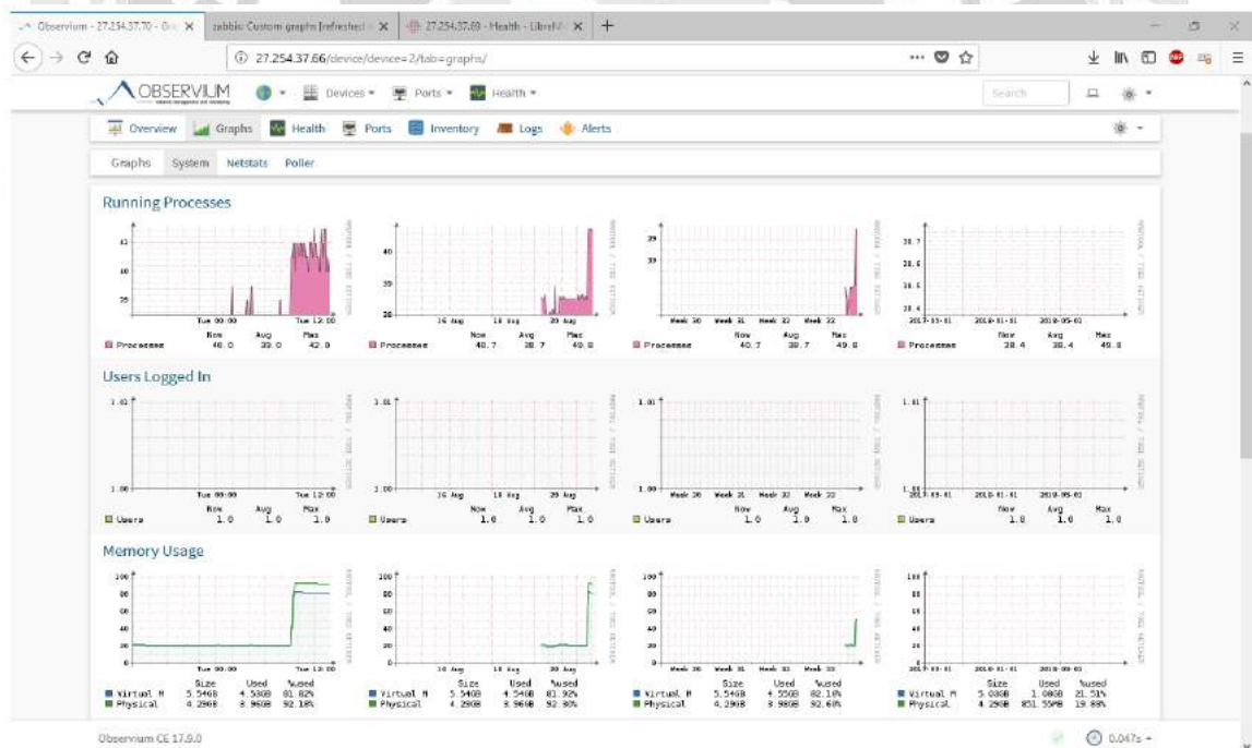
รูปที่ 4.15 มอนิเตอร์ Running process และ Memory usage ด้วย Observium
