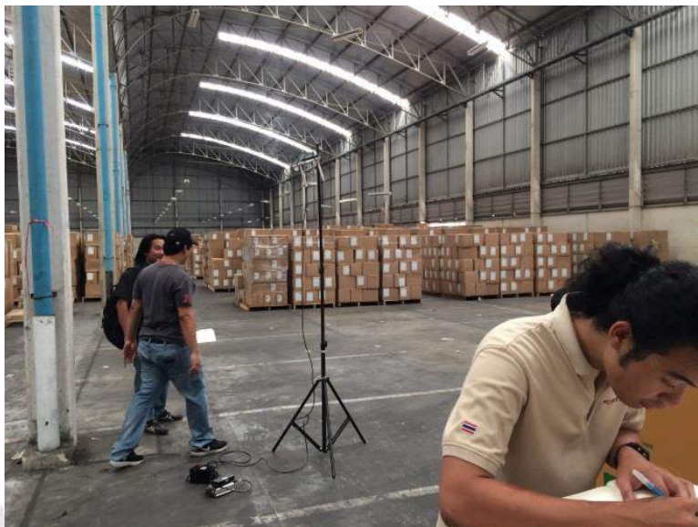
รูปที่ 3.8 จดบันทึกความแรงของสัญญาณจาก Access point
