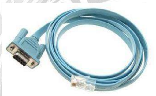
รูปที่ 4.6 สายคอนโซล
