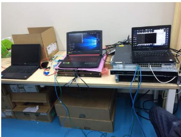
รูปที่ 3.12 ทดลอง ping ระหว่างแลปทอปสองเครื่องผ่านสวิตช์
