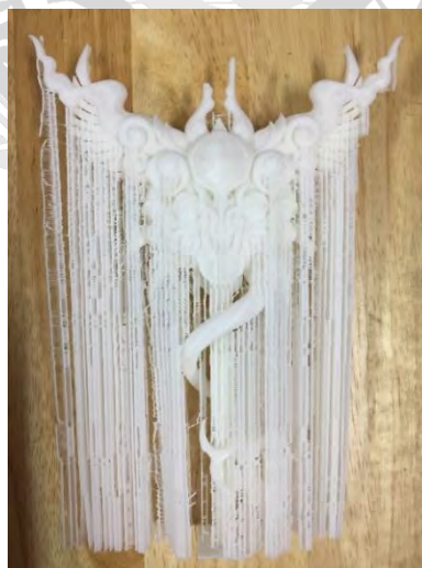
ภาพที่ 4.10 การวางแบบชิ้นงานไม่ดี
