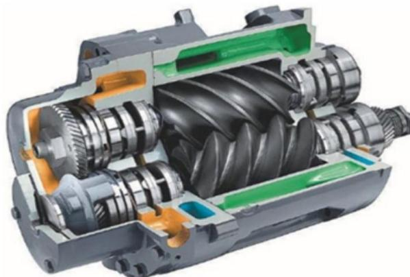
รูปที่ 2.3 คอมเพรสเซอร์แบบสกรู
