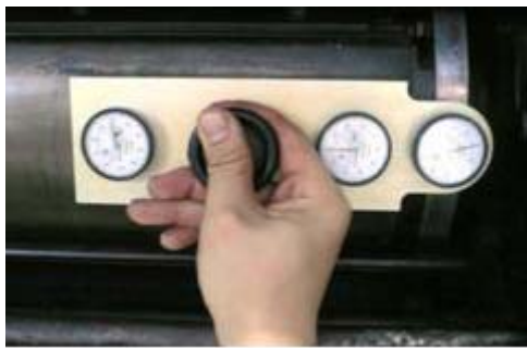
รูปที่ 15. แสดงการวัดระยะป่าโมแม่พิมพ์ด้วยเครื่องมือวัดการหมุนที่สร้างขึ้น
