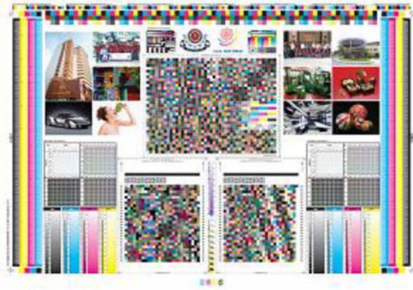
รูปที่ 16 สร้างแม่พิมพ์ที่ใช้สำหรับการทดสอบเครื่องพิมพ์โดยมีแถบควบคุมสำหรับทดสอบคุณภาพงานพิมพ์
