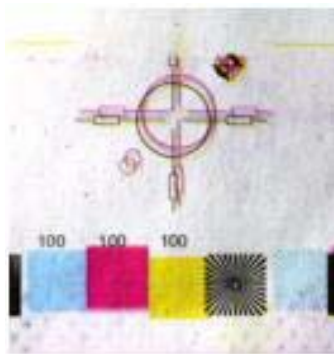
รูปที่ 19 (ก) การพิมพ์โดยไม่ปรับตั้งระยะรองหนู
