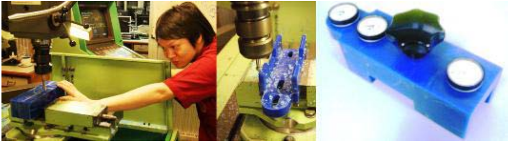
รูปที่ 6. ทดลองขึ้นรูปด้วยวัสดุทดลอง Machinable Wax
