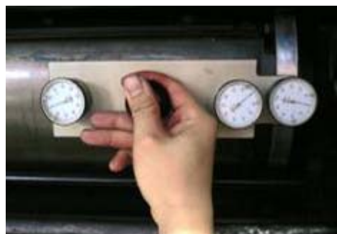
รูปที่ 14. แสดงการวัดระยะป่าโมแม่พิมพ์ด้วยเครื่องมือวัดการหนูนำเข้าจากต่างประเทศ
