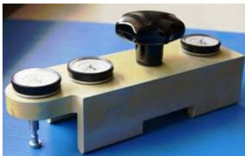
รูปที่ 12. เครื่องมือวัดร่องหนูน (Packing Gauge) ที่สร้างเสร็จพร้อมนำไปทดสอบเก็บรวบรวมข้อมูล
