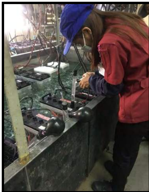
รูปที่ 10 เก็บค่าความถี่จําเพาะในขณะที่ชาร์จแบตเตอรี่
