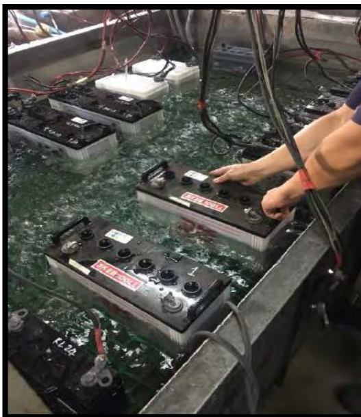
รูปที่ 3.4 ขั้นตอนการชาร์จไฟเข้าแบตเตอรี่ทดสอบ
