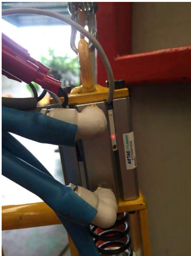
รูปที่ 4.8 กระบอกลม C แบบคอมแพค Clamping Cylinder
