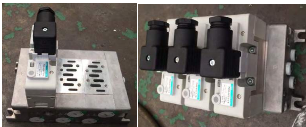
รูปที่ 4.2 การติดตั้งโซลินอยด์วาล์วเข้ากับฐาน
