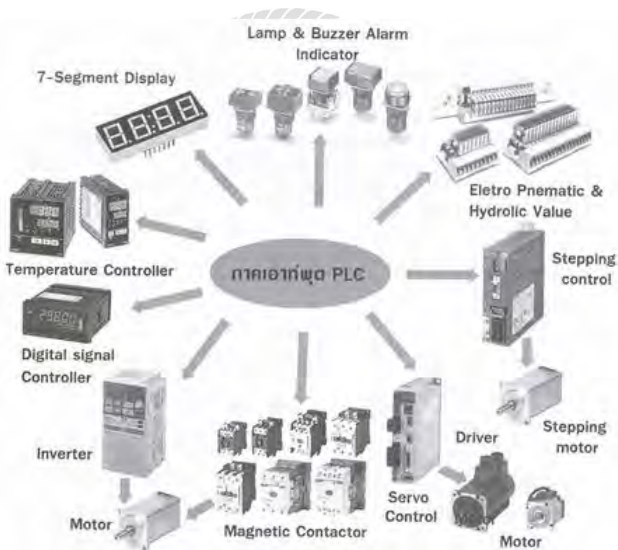
รูปที่ 2.24 ตัวอย่างอุปกรณ์ที่เป็นเอาต์พุตของพีแอลซี
