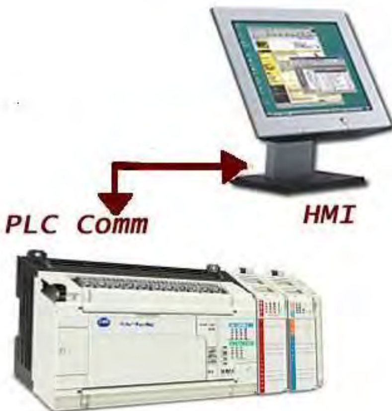
รูปที่ 2.28 การเชื่อมต่อทัชสกรีนกับพีแอลซี
