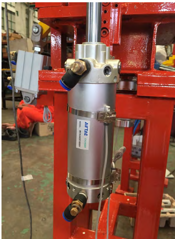
รูปที่ 4.6 กระบอกลม A จับยึดจับชิ้นงาน Clamping Cylinder
