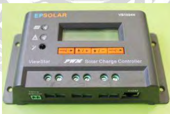
รูปที่ 2.7 โซล่าชาร์จคอนโทรลแบบ PWM
