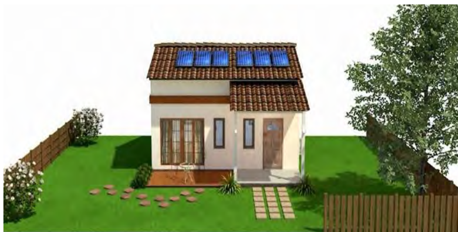
รูปที่ 2.14 ตำแหน่งการติดตั้งแผงโซลาร์เซลล์
