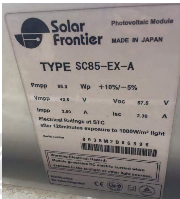
รูปที่ 4.2 Name Plate ของแผงโซลาร์เซลล์
