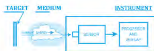
รูปที่ 2.1 หลักการทำงานของเทอร์โมมิเตอร์แบบอินฟราเรด
