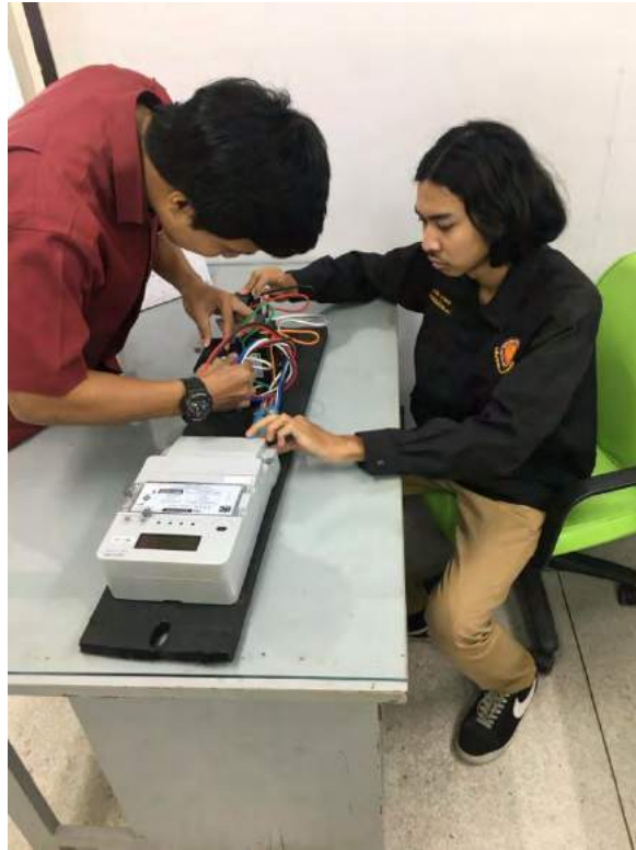
ภาพผนวก ก รูปที่ 20 ติดตั้งมิเตอร์ TOU และ CT
