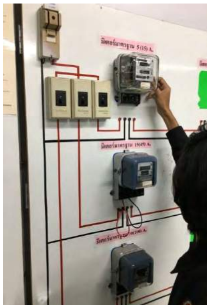
รูปที่ 4.3 การทดสอบมิเตอร์โดยใช้แผงวงจรเทียบ
