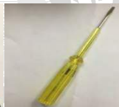
รูปที่ 3.23 ไขควงปากแบนและไขควงแฉก รูปที่ 3.24 ไขควงวัดไฟ
