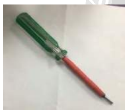
รูปที่ 3.23 ไขควงปากแบนและไขควงแฉก รูปที่ 3.24 ไขควงวัดไฟ
