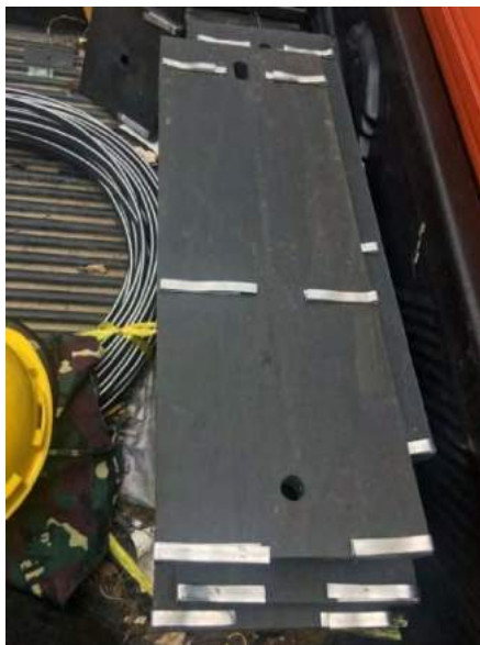
รูปที่ 4.5 แผ่นไม้ทำการติดเข็มขัดรัดสาย
