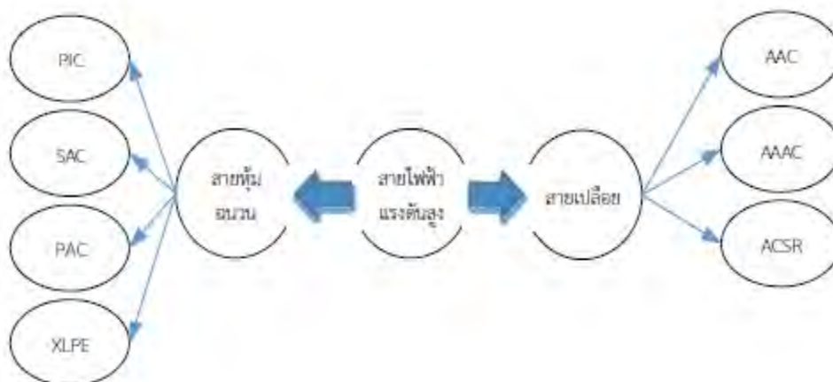
รูปที่ 2.21 สายไฟฟ้าแรงดันสูง
