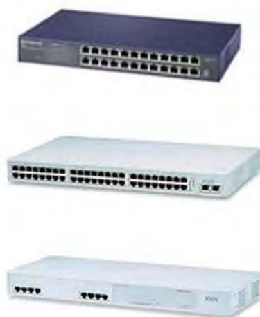
รูปที่ 2.14 Switch
