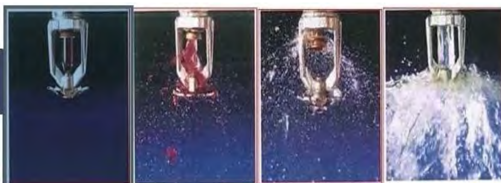
รูปที่ 4.10 การทำงานของหัวสปริงเกอร์
