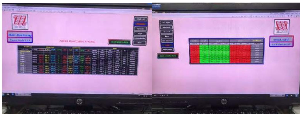
รูปที่ 4.3 จอแสดงค่ากระแส แรงดัน และ สถานะของตู้ MDB
