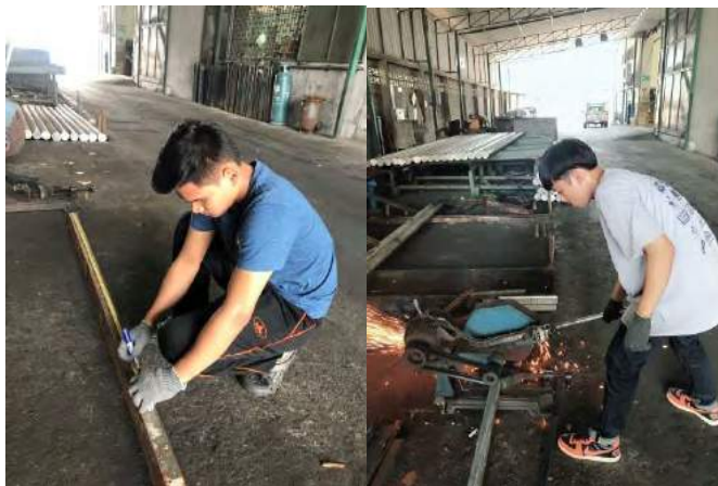
รูปที่ 4.15 วัดขนาดที่คั่นและตัดชิ้นงาน
