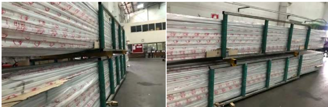
รูปที่ 4.19 การใช้งานที่คั่นวางตะกร้าใส่อลูมิเนียม
