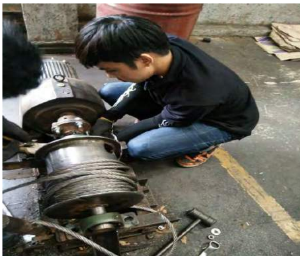
รูปที่ 4.39 ทำการขี้น็อต ตรวจสอบแกนเก็บสายสลึง
