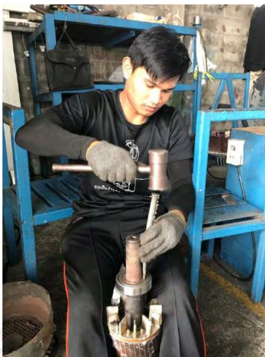
รูปที่ 4.45 ประกอบลูกปืนใหม่ใส่โรเตอร์ หลังจากที่ถอดชุดลูกปืนเก่าออกแล้วทำการตอกใส่ชุดลูกปืนใหม่เข้ากับโรเตอร์
