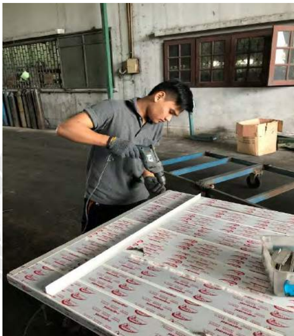
รูปที่ 4.34 ติดตั้งส่วนที่ใช้เป็นพื้นโต๊ะ
