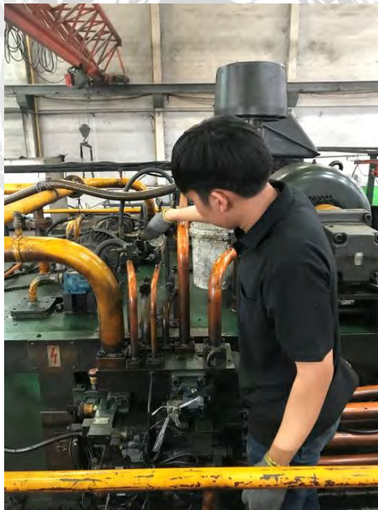
รูปที่ 4.1 ตรวจสอบแรงดันซิลคองเทนเนอร์ของเครื่องรีดอูมิเนียม
