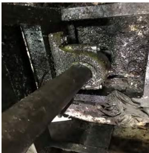
รูปที่ 4.61 ติดตั้งประกอบชุดลูกปืนเตาอบ
