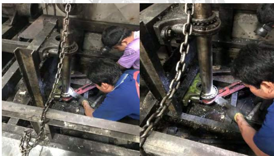
รูปที่ 4.62 ประกอบฝากรอบชุดลูกปืนและเพลานี้เพื่อพัฒนาเตาอบ
