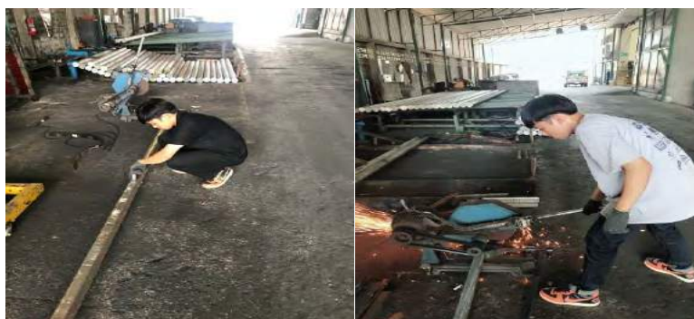
รูปที่ 4.21 วัดขนาดชิ้นที่กั้นและตัดชิ้นงาน
