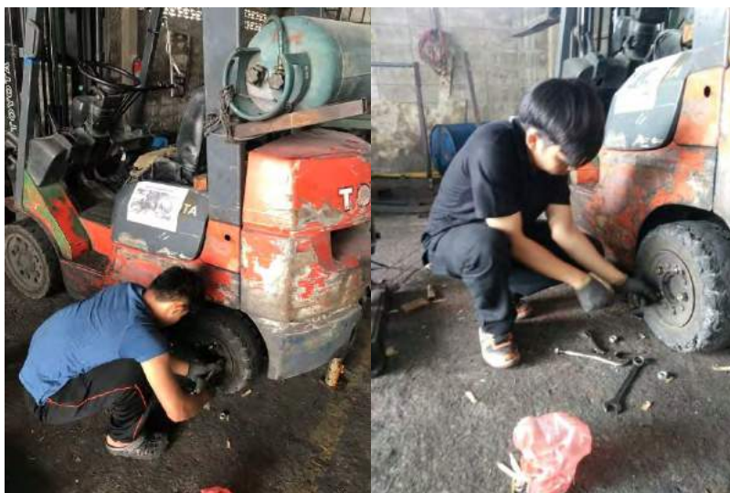
รูปที่ 4.51 เปลี่ยนน็อตล้อรถโฟล์คลิฟท์
