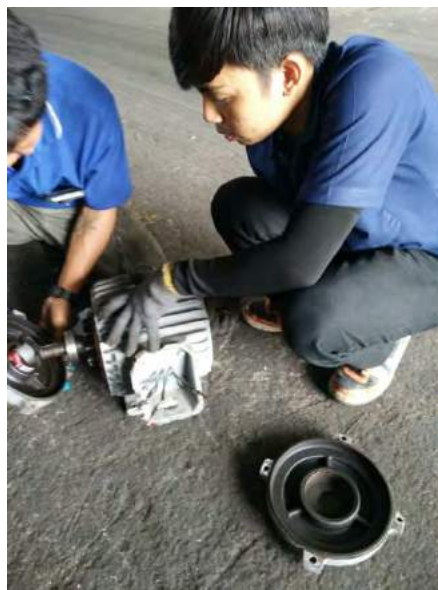
รูปที่ 4.43 ยกโรเตอร์ออกจากโครงมอเตอร์
