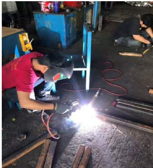
รูปที่ 4.29 เชื่อมส่วนที่เป็นขาโต๊ะ
