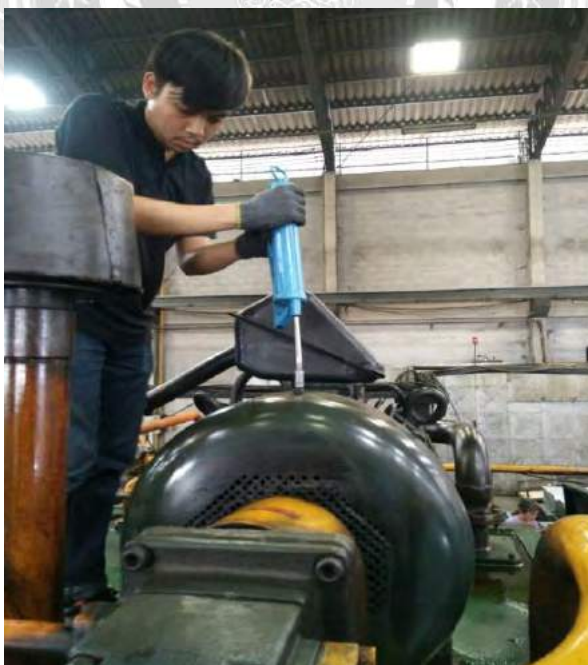
รูปที่ 4.54 อัดจารบีมอเตอร์เครื่องรีดลูมิเนียม
