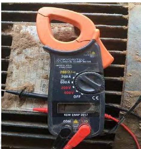
รูปที่ 4.41 ปรับมัลติมิเตอร์ไปที่โหมดโอห์ม
