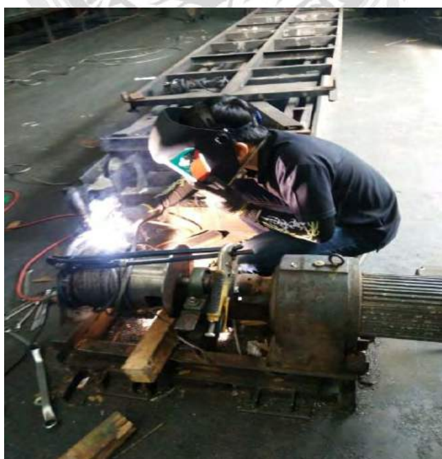
รูปที่ 4.38 เชื่อมซ่อมแกนหม้อสายสลิง
