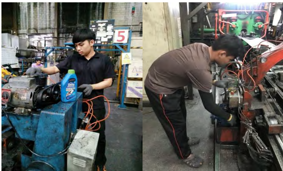
รูปที่ 4.4 ตรวจเช็คปั๊มลมพลูเลอร์และเติมน้ำมันปั๊มลมพลูเลอร์
