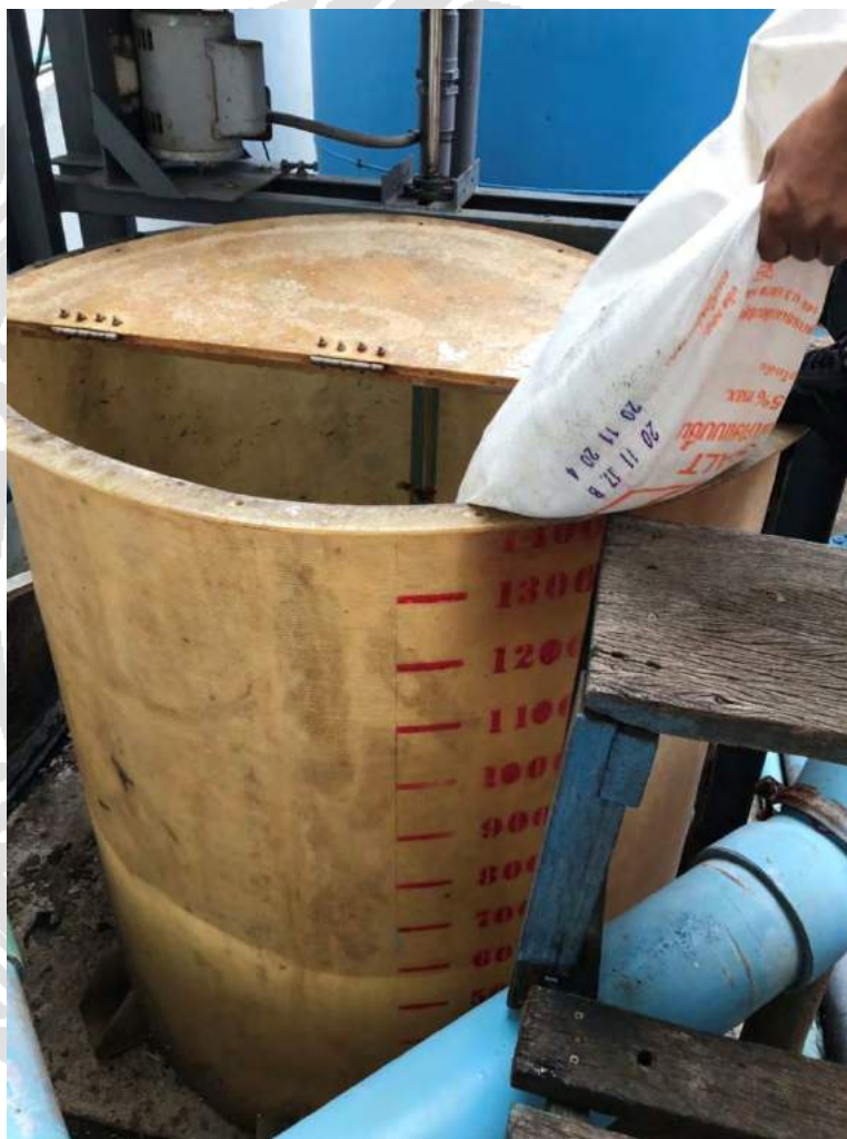
รูปที่ 4.8 ถึงเตรียมน้ำเกลือขนาด 1,300ลิตร
