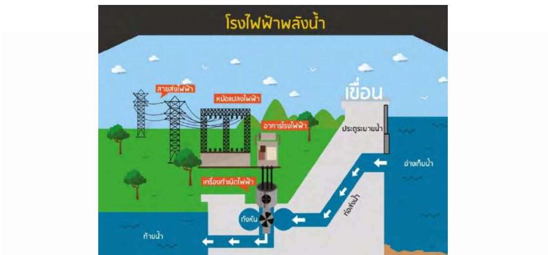
รูปที่ 2.17 โรงไฟฟ้าพลังน้ำ
