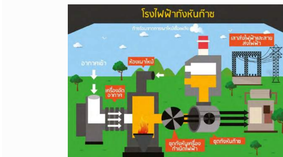
รูปที่ 2.18 โรงไฟฟ้ากังหันก๊าซ
