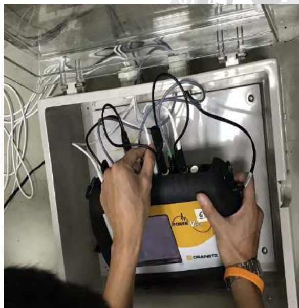
รูปที่ 8 ขั้นตอนการติดตั้ง PQ Meter (Power Quality Meter) ขณะมีโหลดและ ต้องลำดับเฟสให้ ถูกต้องเพื่อให้ PQ Meter มีประสิทธิภาพสูงสุด
