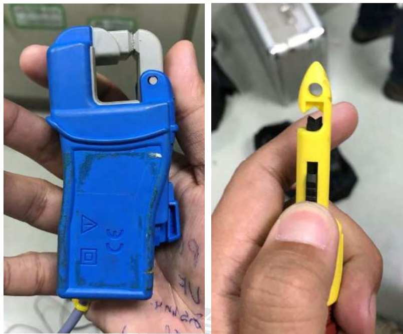
รูปที่ 7 อุปกรณ์ที่ใช้ตรวจสอบแรงดันไฟฟ้าและกระแสไฟฟ้าจะถูกติดตั้งอยู่ที่สายไฟเข้า-ออก ของเมนเบรกเกอร์
