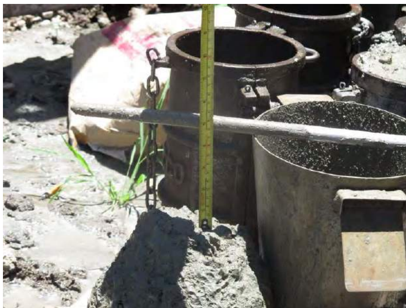
รูปที่ 4.4.7 การตรวจ Slump (ก.)
