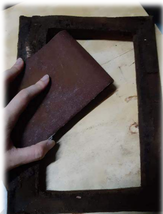
ภาพที่ 4.4.3 การนำแผ่นกากกาแฟมาขัดด้วยกระดาษทราย (เบอร์ 80 และขัดต่อด้วย เบอร์ 120)
