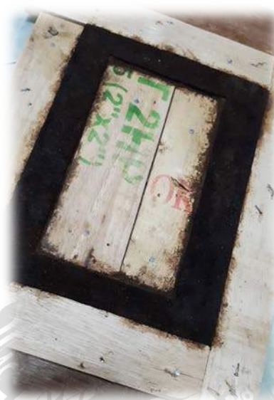
ภาพที่ 4.4.1 การขึ้นรูปกรอบรูป และนำกรอบรูปไปตากแดด 3 วัน
