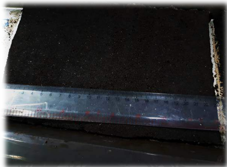
ภาพที่ 4.3.1 การอัดกากกาแฟเป็นรูปทรงสี่เหลี่ยมผืนผ้า กว้าง 16 ซม. ยาว 22 ซม.หนา 0.5 ซม.
