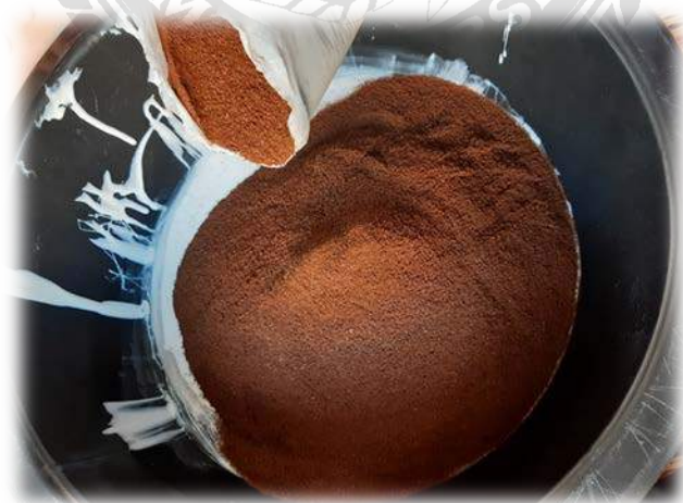
ภาพที่ 4.2.2.2 การนำกากกาแฟที่แห้งแล้วในปริมาณ 500 กรัม นำมาผสมกาวลาเท็กซ์ที่เตรียมไว้
