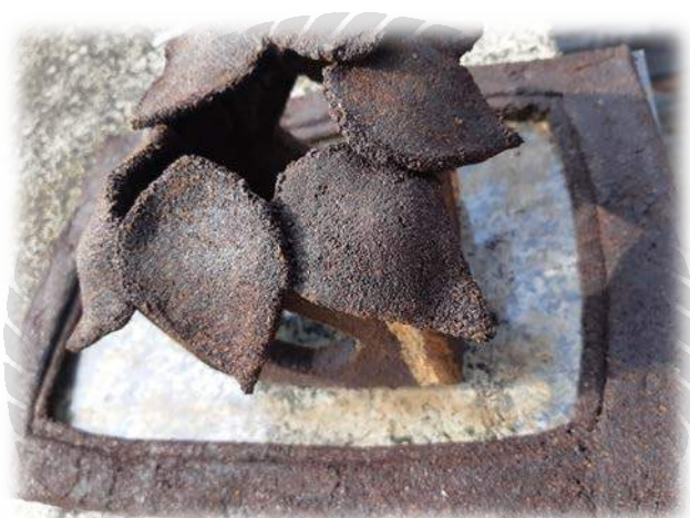
ภาพที่ 4.5.4 การนำชิ้นส่วนของคอมไฟประกอบกัน และนำไปตากแดด 3 วัน
