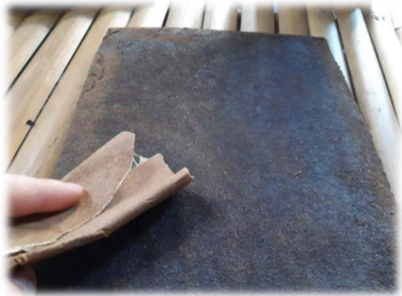
ภาพที่ 4.3.3 การนำแผ่นกากกาแฟมาขัดด้วยกระดาษทรายเบอร์ 80 และขัดต่อด้วยเบอร์ 120 เมื่อขัดเสร็จแล้วปิดฝุ่นของกากกาแฟออกให้หมด
