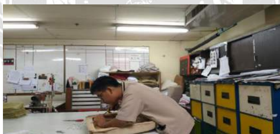
รูปที่ 3.32 แกะแม่็กออกจากเก้าอี้และเอาผ้าออก
