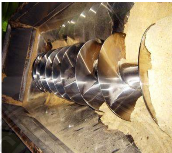
รูปที่ 1.4 สกรูที่ใช้ในการบดวัตถุดิบให้ละเอียด
